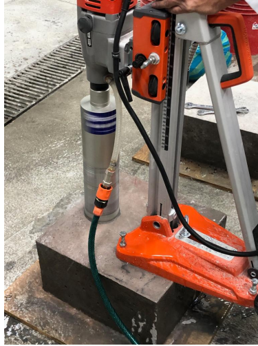
Figura 17: Proceso de extracción de núcleos
