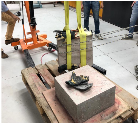
Figura 15: Bloques para curado en seco y en piscina de curado
