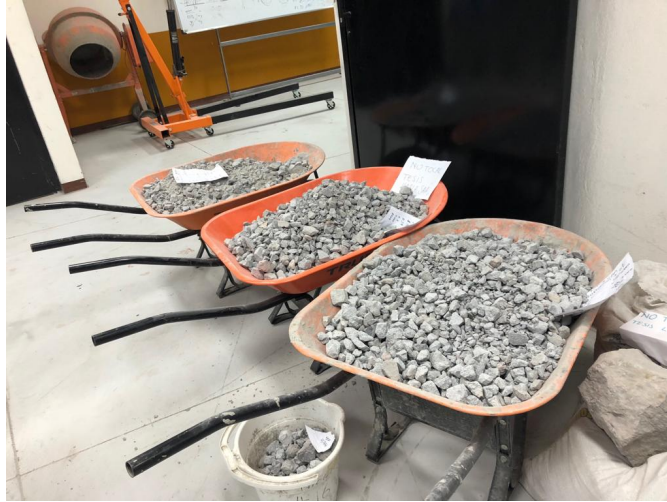
Figura 9: Dosificación de materiales
