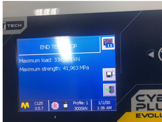
Figura 23: Ejemplo de Resultado de resistencias obtenidas en cilindros
