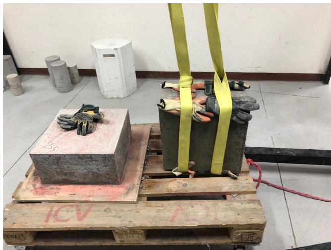
Figura 16: Bloques para curado en seco y en piscina de curado
