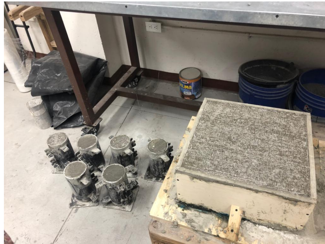
Figura 12 : Enconfrado y cilindros de las mezclas dosificadas
