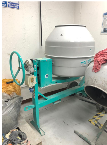
Figura 10: Concretera utilizada "ImerGroup"
