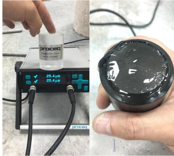
Figura 8: Material de Calibración y Agente de Acoplamiento.
