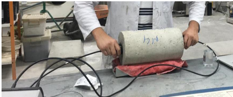
Figura 9: Configuración Usada para Medir Velocidad de Pulso.
