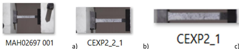
Figura 8: Post-procesamiento del video del ensayo de calibración a) Conversión del video en fotos b) Cambio de nombre y enumeración a las fotos obtenidas a partir del video c) Ajuste del área de las fotos al área que se desea realizar el DIC
