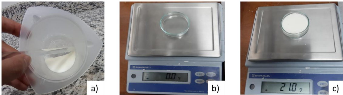
Figura 10: a) Mezcla de maicena y agua para realizar los ensayos de agrietamiento c) Petri previamente preparado para realizar los ensayos de agrietamiento c) Muestra final de maicena y agua utilizada para los ensayos de agrietamiento.
