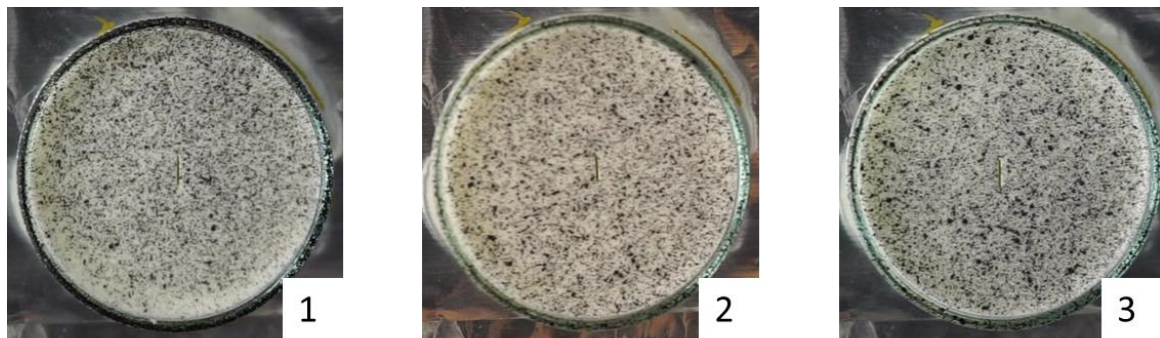
Figura 25: Imágenes de referencia introducidas en el Ncorr para cada ensayo de agrietamiento de muestras de almidón de maíz y agua
