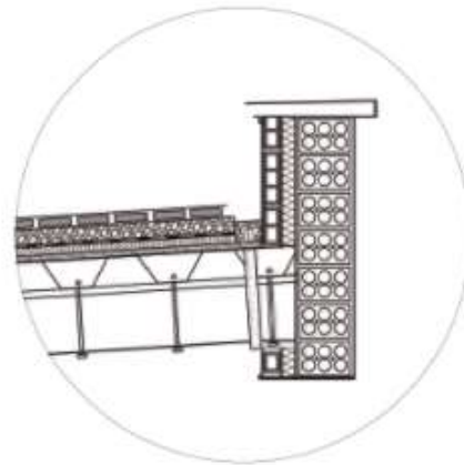
VACAS GALINDO LODGE DETALLE DESAGUE TECHOS ESCALA 1:25
