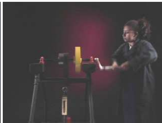
Figura 6. Dinamómetro de resorte
