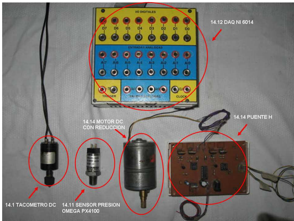
Figura 16 Imagen los elementos 14.1 14.11 14.12 14.14 que se utilizaron para la implementación de la red electrónica de la automatización.
