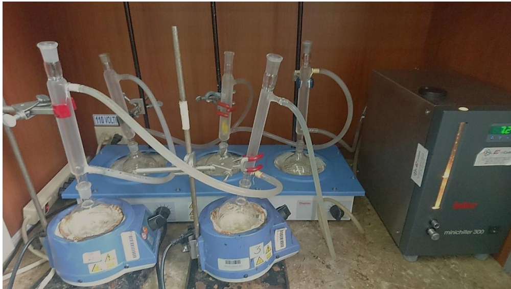
Figura 6.1. Sistema de reflujo para los pretratamientos a la mazorca de la cáscara de cacao
