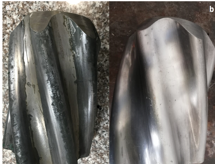
Figura 5. Rotor antes y después de soldadura de corrección
