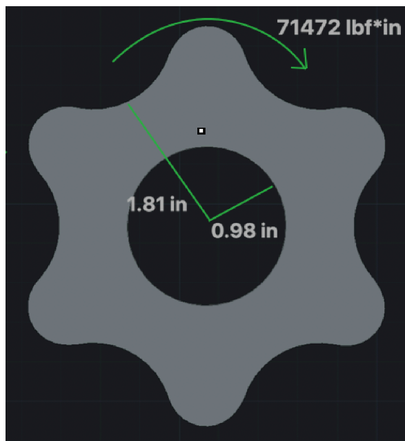
Figura 8. Diseño de rotor con dimensiones y torque
