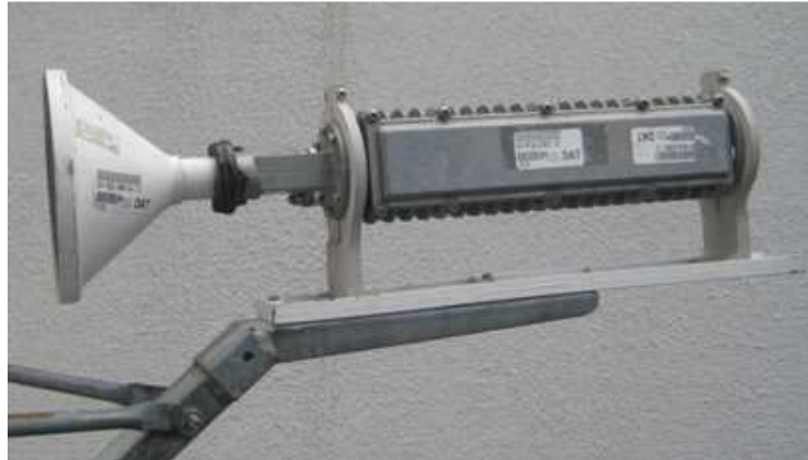
Figura 4.7. Unidad de Radio y Feed. (Imagen real proporcionada por el ISP).
