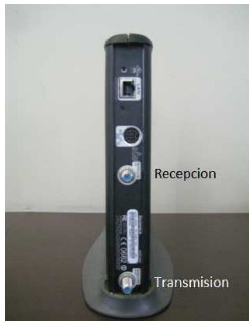
Figura 4.12. IDU, DirecWay 6000. (Imagen real proporcionada por el ISP).
