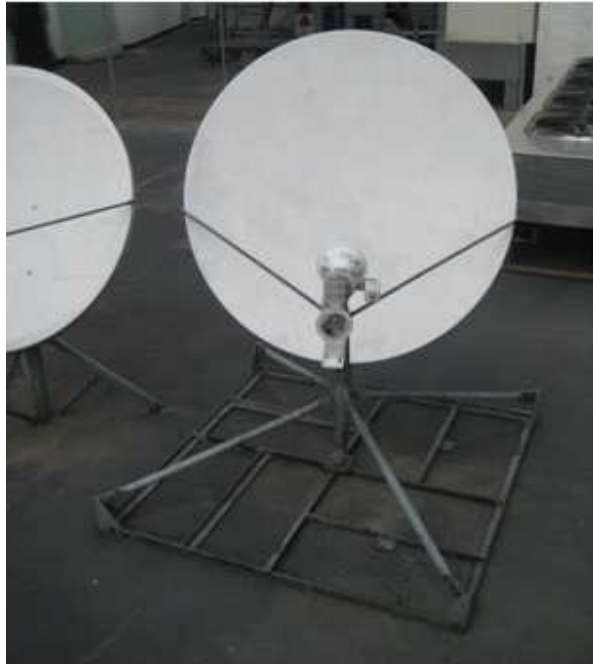
Figura 4.6. Herrajes de soporte de ODU y plato de antena. (Imagen real proporcionada por el ISP).
