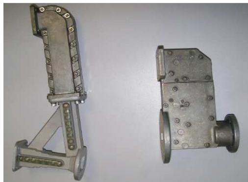
Figura 3.14. Aditamentos de alimentador para polarización paralela y polarización cruzada respectivamente. (Fotografía real proporcionada por el ISP)
