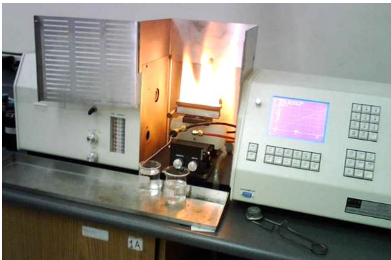
Figura 3.3 Fotografía del espectrofotómetro de absorción atómica Buck Scientific® 210VGP en operación.
