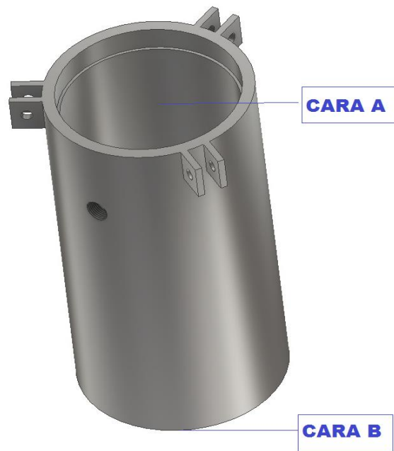
Figura 16. Denominación del mecanizado de la carcasa.
