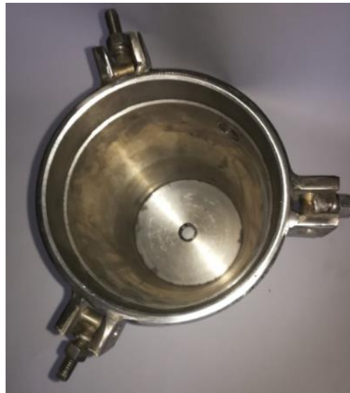
Figura 35. Ensamble Carcasa/ Tapa inferior (Vista Superior).
