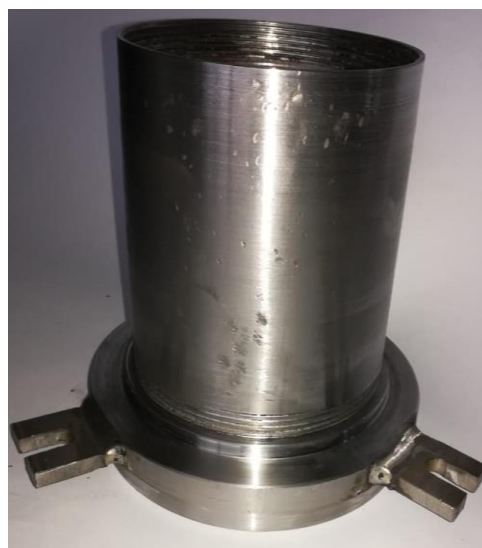
Figura 27.- Elemento final: Tubo del visor ensamblado a la tapa superior.
