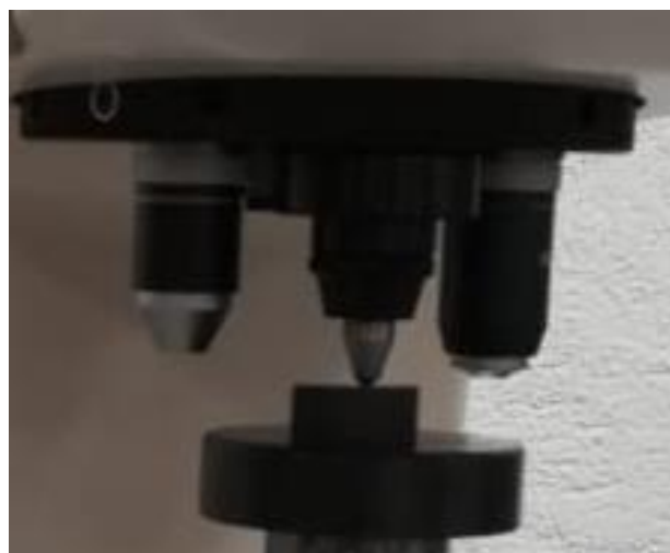
Figura 46. Medición de dureza mediante indentador Vickers.
