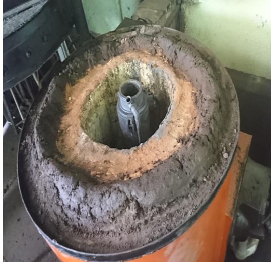
Figura 42. Colocación de la mezcla arena y agua en el horno.
