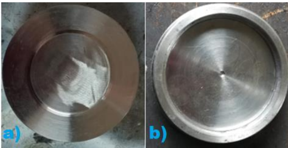
Figura 29.- Elemento final: Tapa del visor. a) Vista superior. b) Vista inferior.
