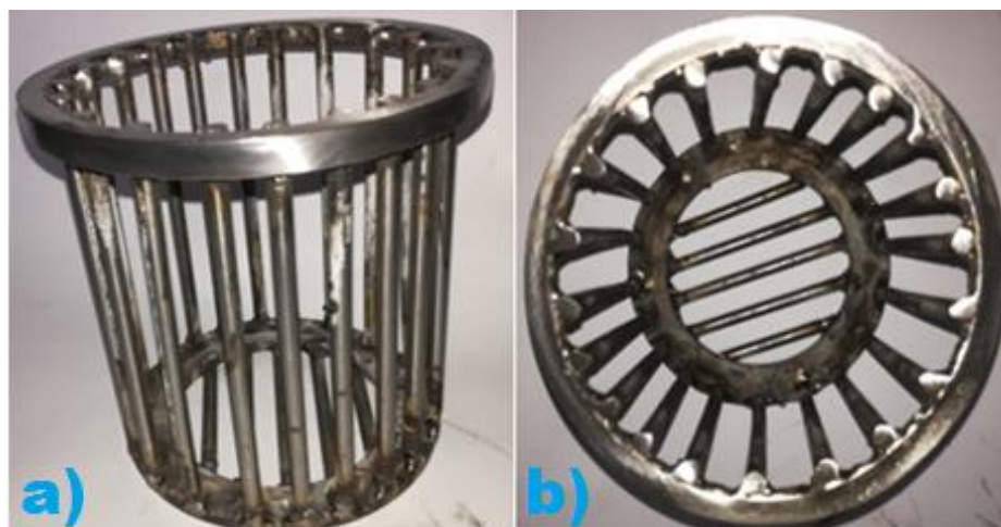
Figura 31.- Elemento final: Contenedor. a) Vista isométrica. b) Vista superior.
