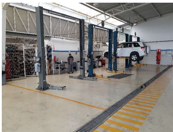
Imagen 15: Fondo del Elevador para Desmontaje Piezas, Motor, Cableado, entre otros.
