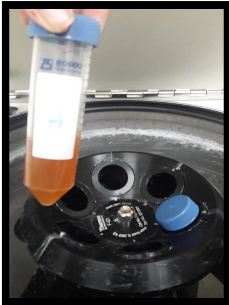
Imagen 8: Extracto de la semilla de aguacate obtenido con agua destilada después de la centrifugación
