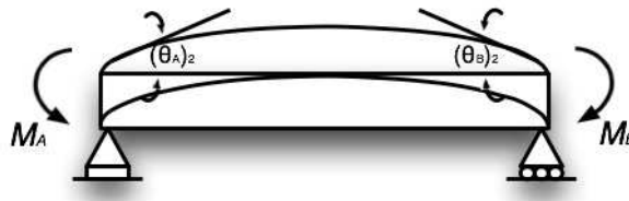
Figura A.16: Esquema de flexión de la viga por momentos en los extremos.
