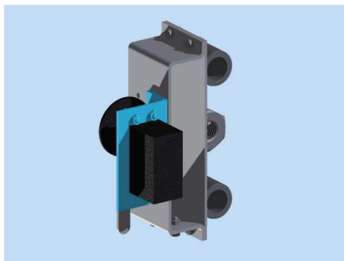
Figura 3.18: Base de servo motor, anclada al coche de desplazamiento.
