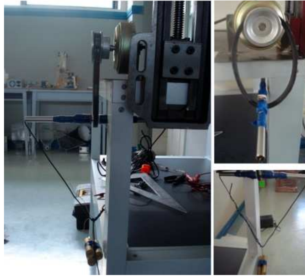
Figura 3.27: Banco de pruebas de desgaste de motor.
