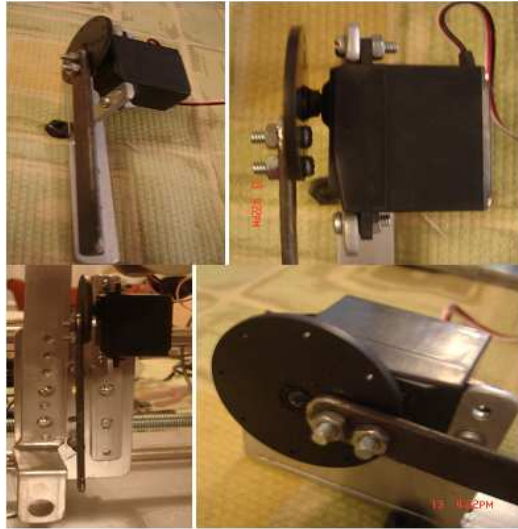
Figura 4.5: Sistema de despacho (Despachador)
