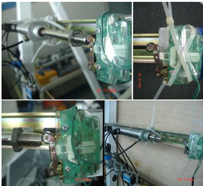
Figura 3.25: Prueba de ciclos de vida de finales de carrera.
