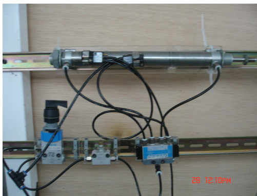
Figura 3.26: Banco neumático de prueba de ciclos de vida.
