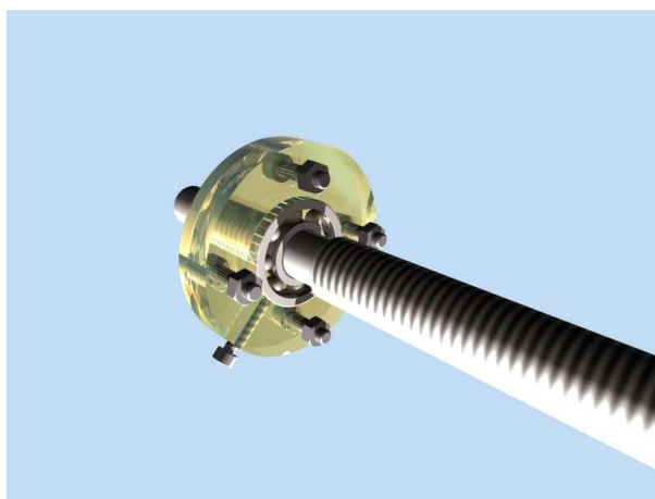
Figura 3.6: Vista en perspectiva de chumacera acoplada a eje roscado.
