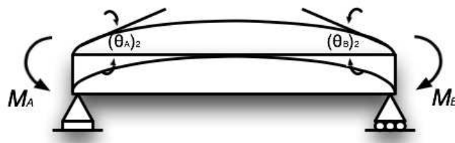
Figura A.13: Esquema de flexión de viga, por momento en punto A.
