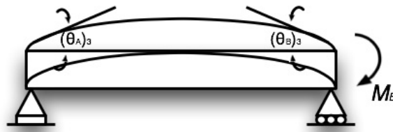
Figura A.12: Esquema de flexión de viga, por momento en punto A.
