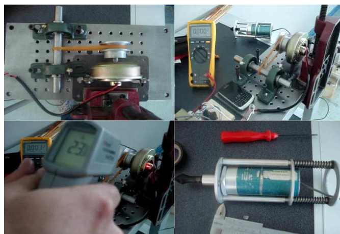
Figura 3.28: Banco de pruebas de desgaste de motor y banda.
