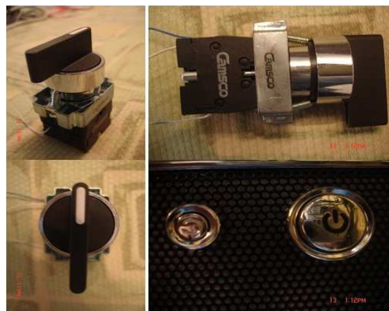
Figura 4.9: Interruptor 3 posiciones y, pulsadores de Encendido y parada.
