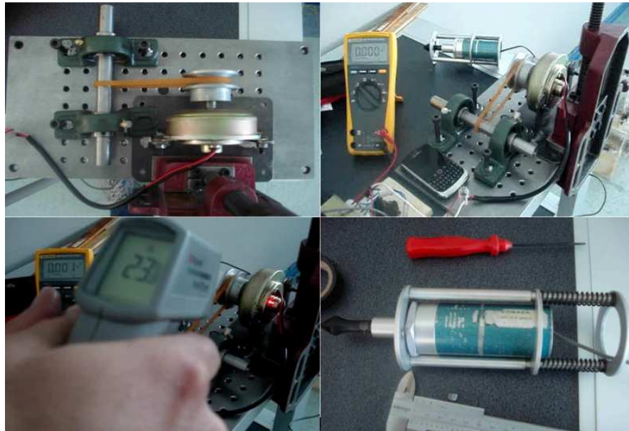
Figura B.3: Prueba ciclos de vida motor.
