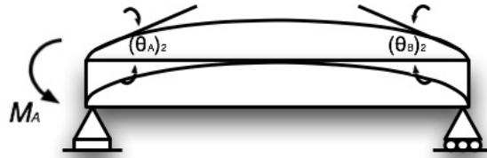
Figura A.11. Esquema de flexión de viga, por momento en punto A.
