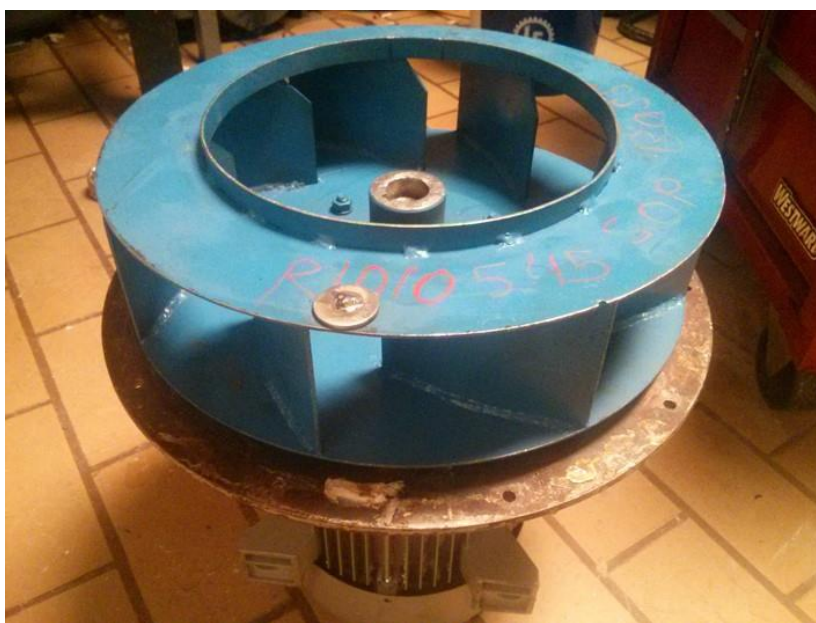
Figura 4.2: Inspección de componentes de un ventilador centrifugo de ventilación. (Maquinaria Ferrero del Ecuador S.A.)
