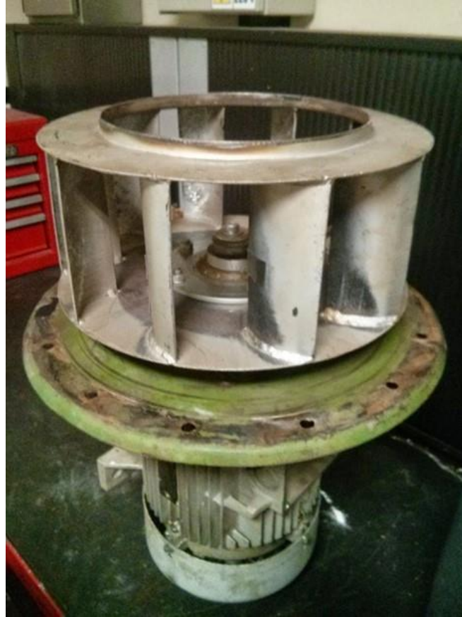
Figura 4.3: Inspección de componentes de un ventilador centrifugo de aspiración. (Maquinaria Ferrero del Ecuador S.A.)
