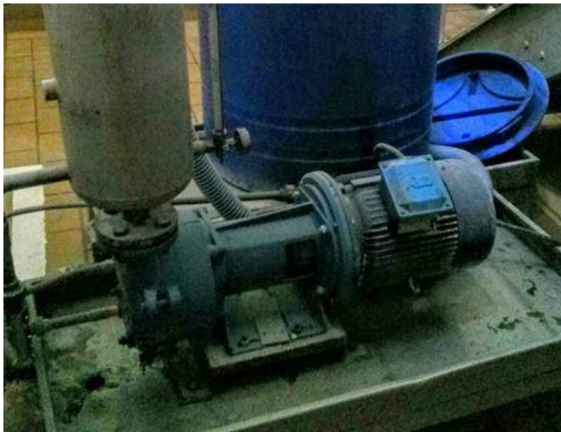
Figura 4.5: Inspección de componentes de la bomba de vacío. (Maquinaria Ferrero del Ecuador S.A.)
