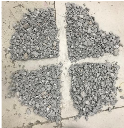
Figura 30: Método de cuarteo ASTM C 702
