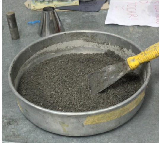
Figura 32: Muestra DE agregado Fino para ensayo de la norma ASTM C 117
