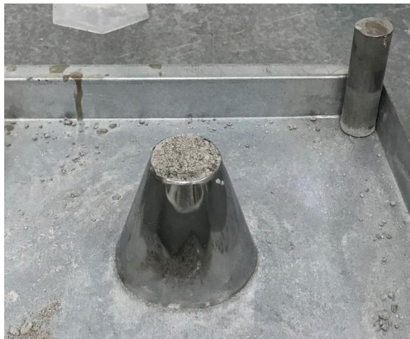
Figura 33: Determinación de masa con superficie saturada seca
