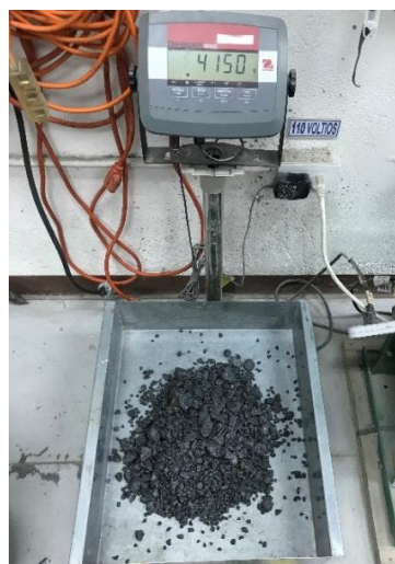
Figura 31: Masa de Agregado Grueso con Superficie Saturada Seca
