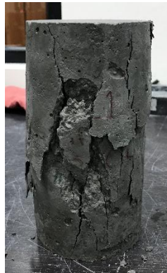
Figura 37: Cilindro después de ensayo a compresión
