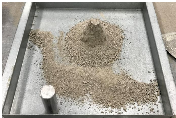
Figura 34: Muestra agregado fino con masa en superficie saturada seca
