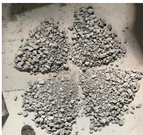
Figura 8: Muestreo de agregado grueso
