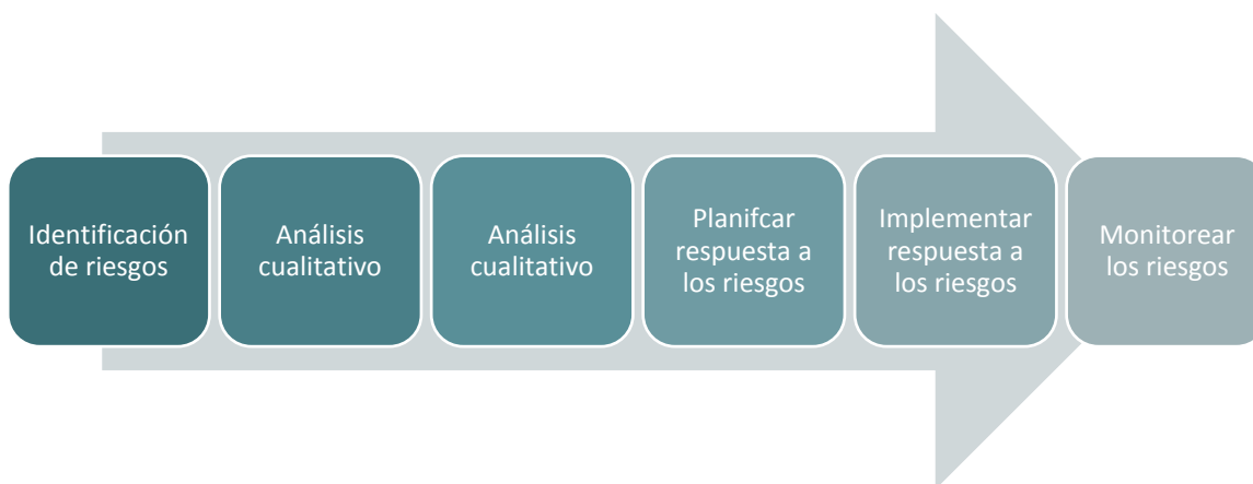
Gráfico 11.4 Proceso de Gestión de riesgos Fuente: (Tenstep Academy, 2017) Elaborado por: Diana Vásquez
