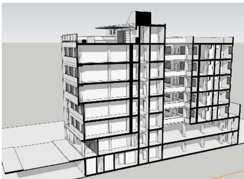
Ilustración 16 Corte volumétrico del edificio Elaboración: El autor
