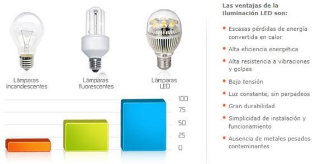
IMAGEN 52: VENTAJAS DE LA ILUMINACIÓN LED
