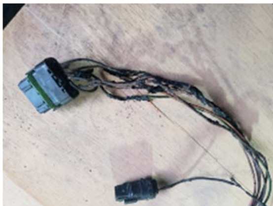
Ilustración 42. CABLEADO CUERPO DE ACELERACION.
