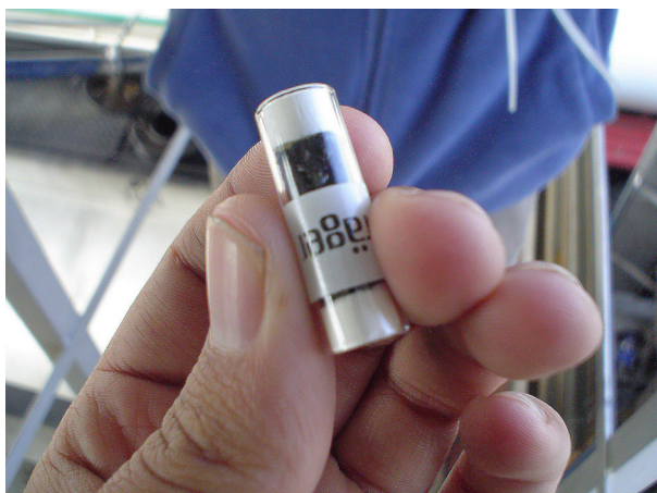
Fotografía 3. Detalle de tupo de muestreo PASSAM ORSA 5. Fuente: elaboración propia.
