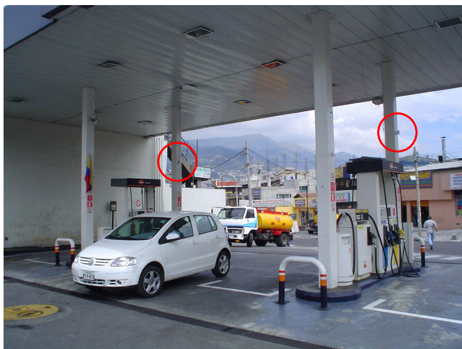
Fotografía 2. Ubicación de los tubos de muestreo pasivo en las islas de carga de las estaciones de servicio. Autor: Gonzalo Banda.
