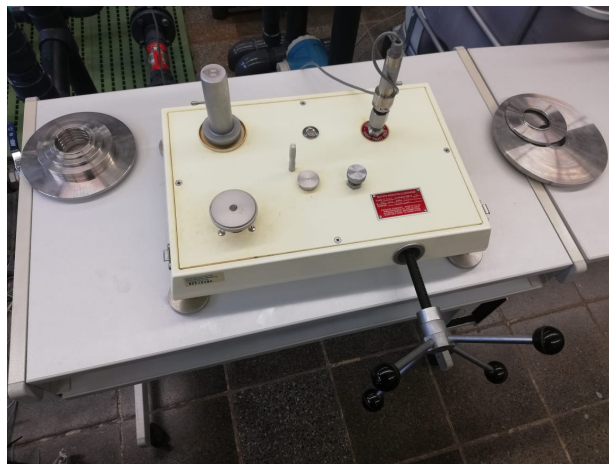
Figura 14. Calibración de sensores de presión.
