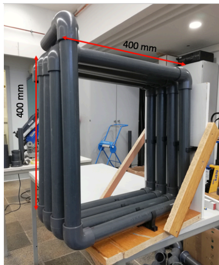
Figura 32. Resistencia hidráulica (espira de tuberías).
