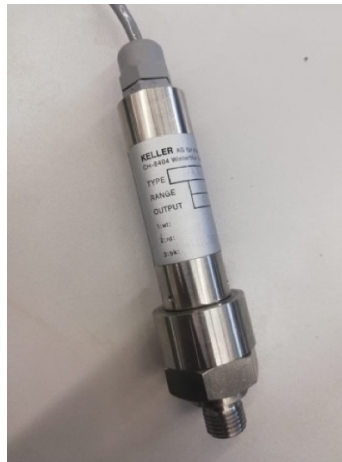
Figura 7. Sensor de presión piezorresistivo
