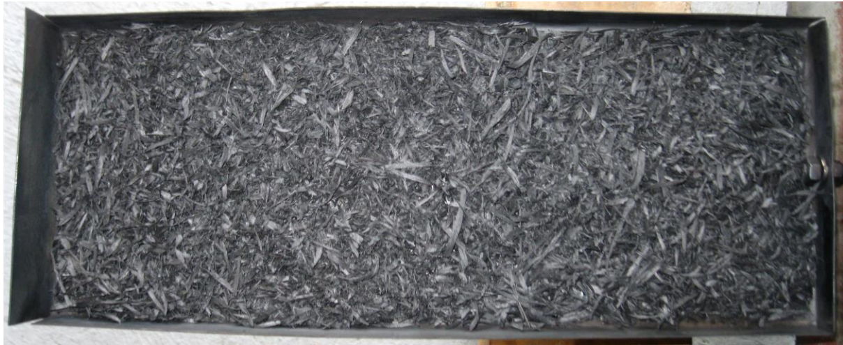
Figura 30. Resultado del calentamiento de la Biomasa hasta una temperatura de 450°C (Biochar)
