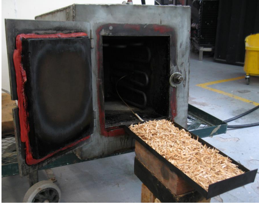
Figura 15. Muestra de biomasa ( Eucalyptus Globulus ) de 300g, astillas de 4mmx20mmx0.5mm aprox.
