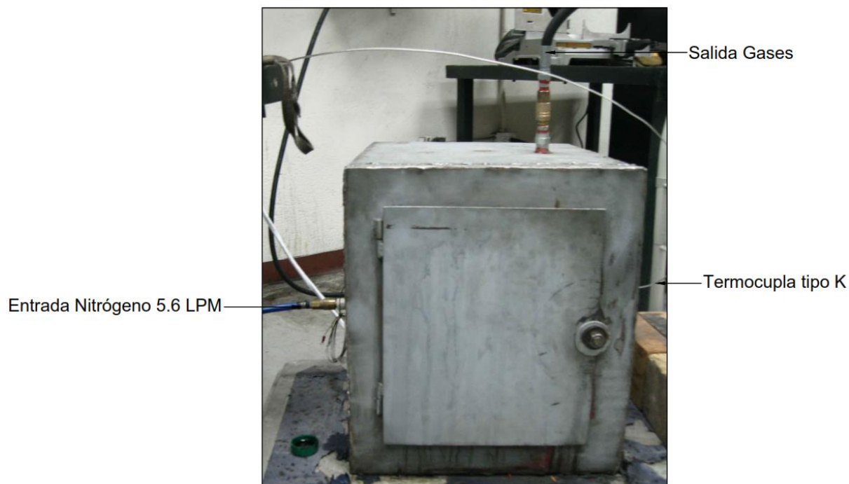
Figura D1. Conexiones del reactor de biochar
