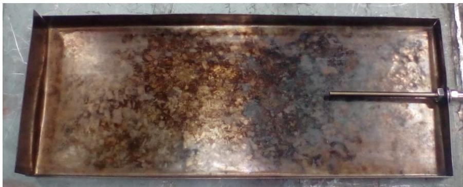
Figura 14. Posición de la termocupla en la bandeja
