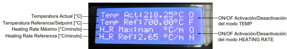
Figura D3. Indicaciones que controlan el modo Temp y Heating Rate
