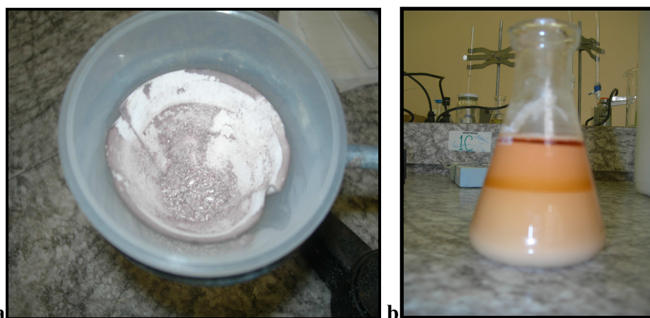
Figura 23: a) sólido obtenido luego de la filtración por gravedad luego del lavado, tetra-n-butilpirogalol[4]areno, b) lavado del sólido obtenido en solución alcohólica al 50%
