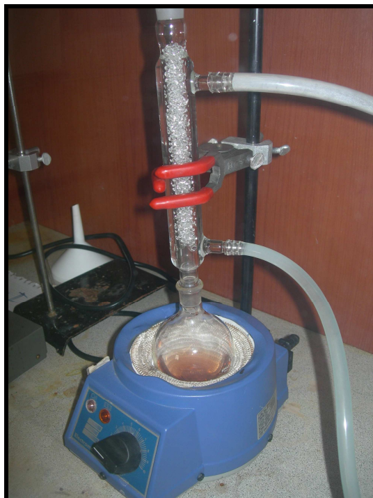
Figura 22: Equipo de reflujo utilizado para la síntesis de tetra-n-butilpirogalol[4]areno.
