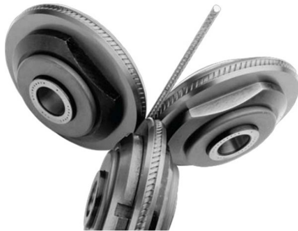
Figura N.6.: Formación de alambre corrugado (EUROLLS, 2014).
