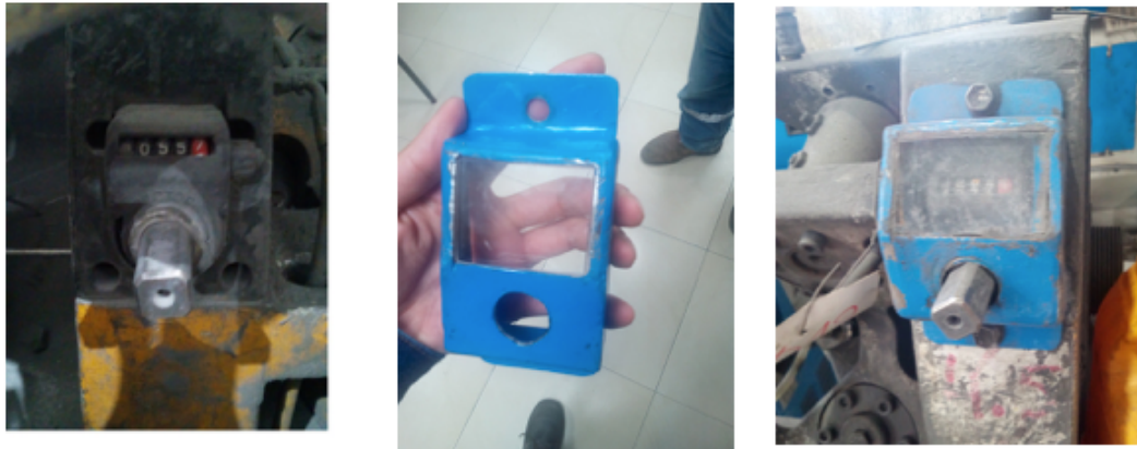
Figura N.37.: Protecciones de cuentavueltas en cabezales grafiladores.
