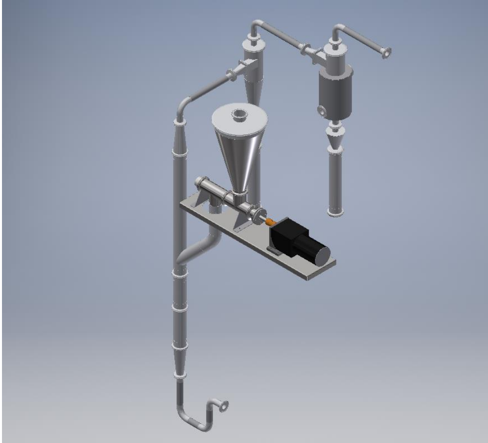
Figura 7. Vista esquemática del Reactor de tipo Lecho Fluidizado
