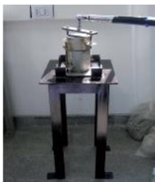
Figura 76. Esquema del dispositivo para medir adherencia
