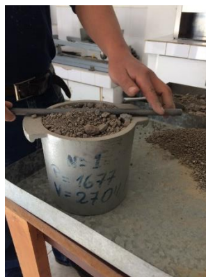
Figura 16. Enrasado de la muestra para ensayo de peso volumétrico
