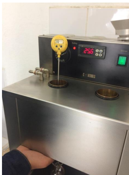
Figura 34. Verificación de la temperatura de la muestra para el ensayo de Viscosidad Saybolt Furol sobre emulsiones asfálticas
