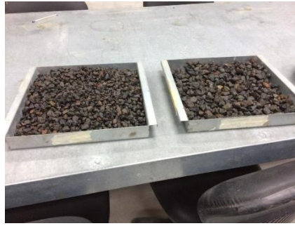
Figura 11. Cantidad de muestra a ensayarse para ensayo de desgaste de los agregados
