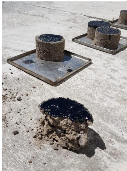
Figura 68. Observación de la penetración de briqueta imprimada con RC-250
