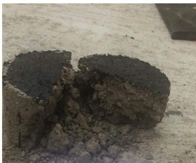
Figura 75. Ruptura de la probeta imprimada con emulsión normal diluida
