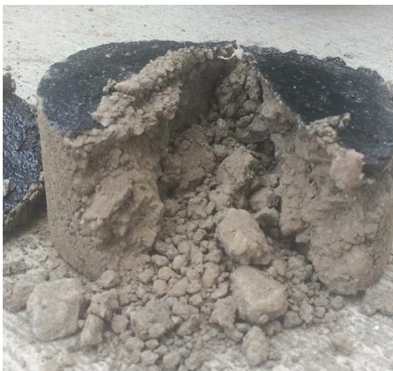
Figura 71. Ruptura de briqueta imprimada con emulsión normal
