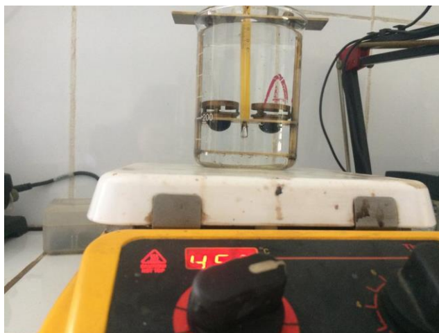
Figura 45. Punto de reblandecimiento de las emulsiones asfálticas
