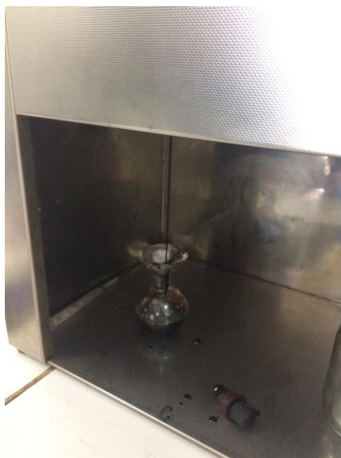
Figura 35.Registro del tiempo en que llena los 60ml de la copa de recepción del ensayo de Saybolt furol sobre emulsiones normal y aditivado
