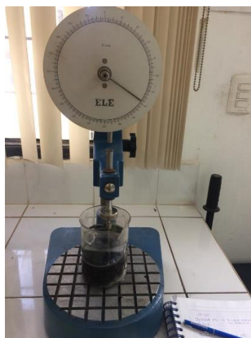
Figura 24. Lectura de penetración en el penetrómetro del ensayo de penetración AC-20 normal y aditivado
