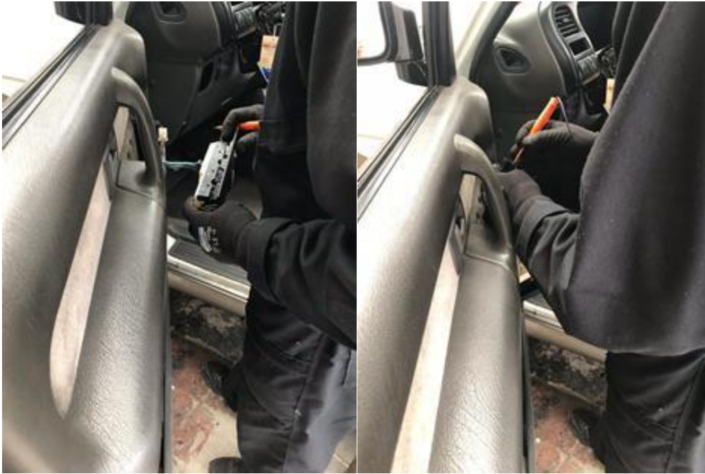
Imagen 30. Comprobación de funcionamiento del bloqueo central (Autor).
