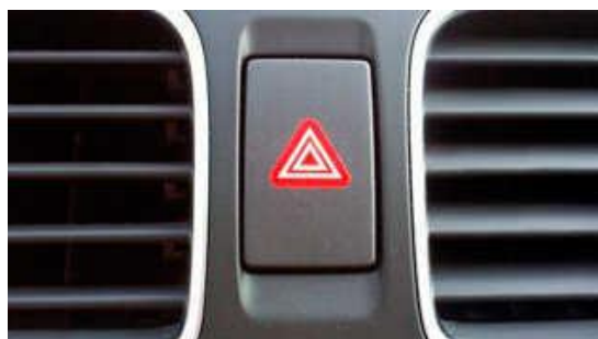
Imagen 14. Botón para poner en funcionamiento el sistema de luces de emergencia
