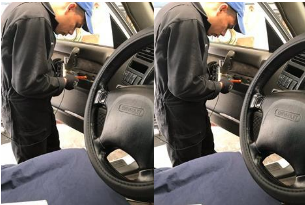
Imagen 31. Comprobación del bloqueo central en la puerta del conductor (Autor).
