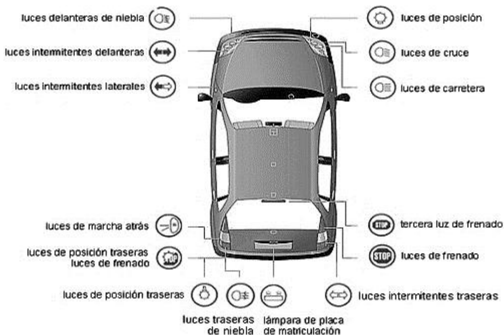
Imagen 18. Identificación de iluminación del automóvil (Oficios técnicos, s.f.).
