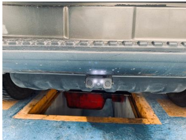
Imagen 55. Cámara y sensores de retro que se puede ver en la pantalla del radio (Autor).
