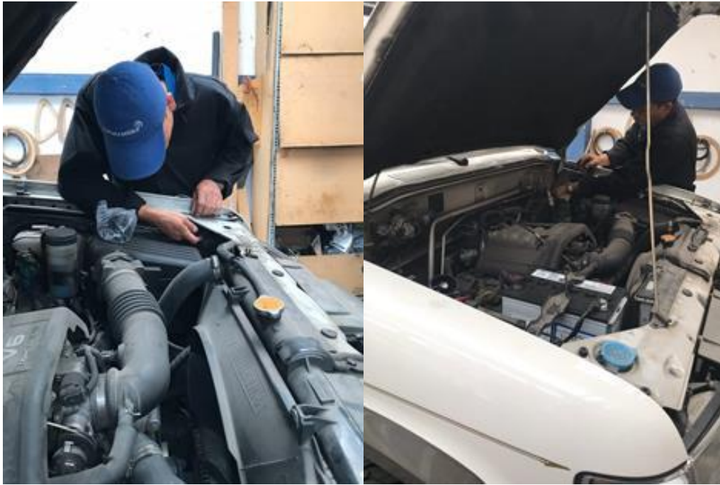
Imagen 41. Comprobación de los cables para la instalación de la alarma Némesis (Autor).
