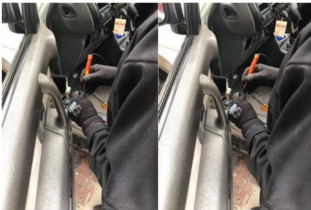
Imagen 29. Comprobación del bloqueo central en la puerta del conductor (Autor).
