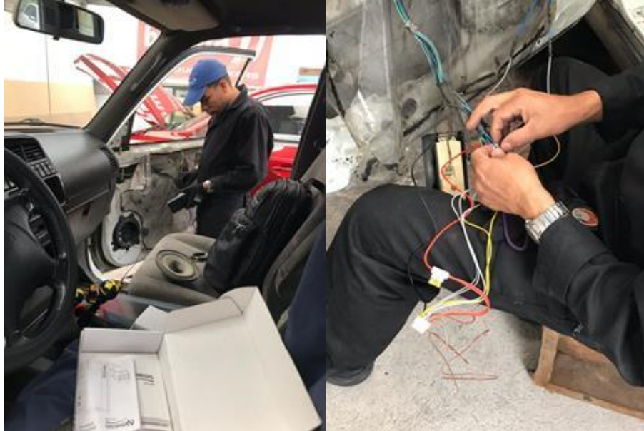
Imagen 33. Instalación de los parlantes en la puerta delantera del copiloto (Autor).
