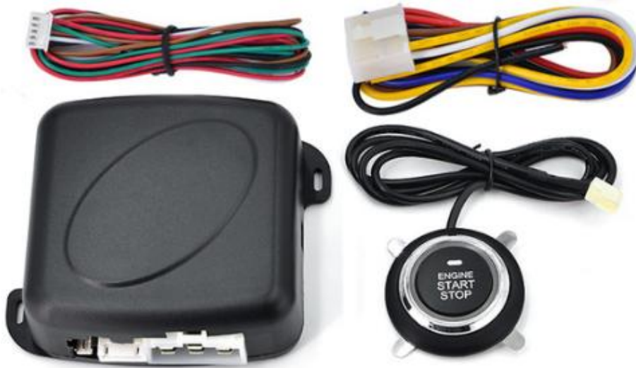
Imagen 24. Ejemplo de sistema de encendido sin llave con botón (Luckyangel_999, 2019).
