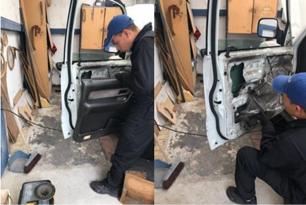
Imagen 36. Desarme de las puertas para ubicar los comandos del bloqueo central (Autor).
