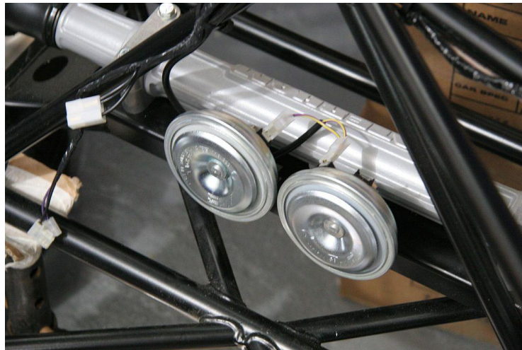
Imagen 15. Bocina eléctrica moderna de automóvil (Wikipedia, 2019).
