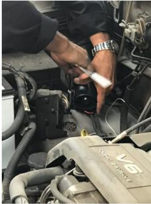
Imagen 42. Sirena ubicada dentro del habitáculo del motor (Autor).
