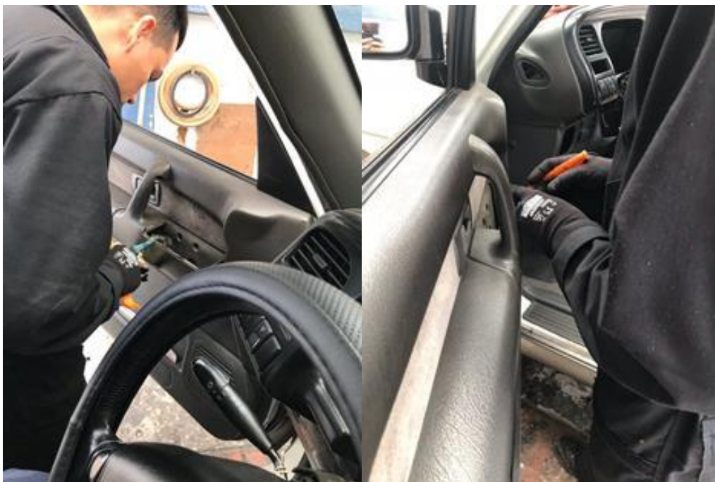
Imagen 28. Desarme del comando de la puerta del piloto para comprobar el bloqueo central (Autor).
