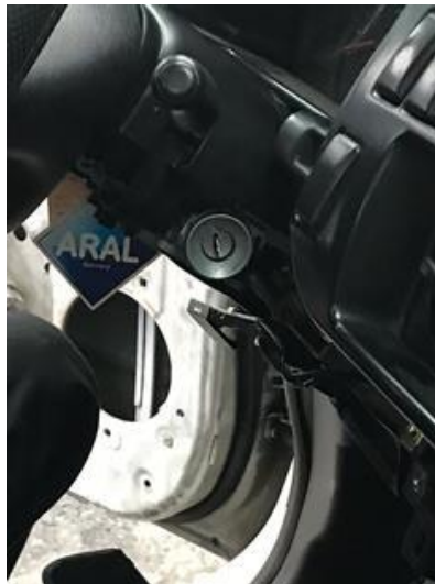
Imagen 27. Copia de llave cortada, dentro del encendido para que funcione el botón de arranque (Autor).
