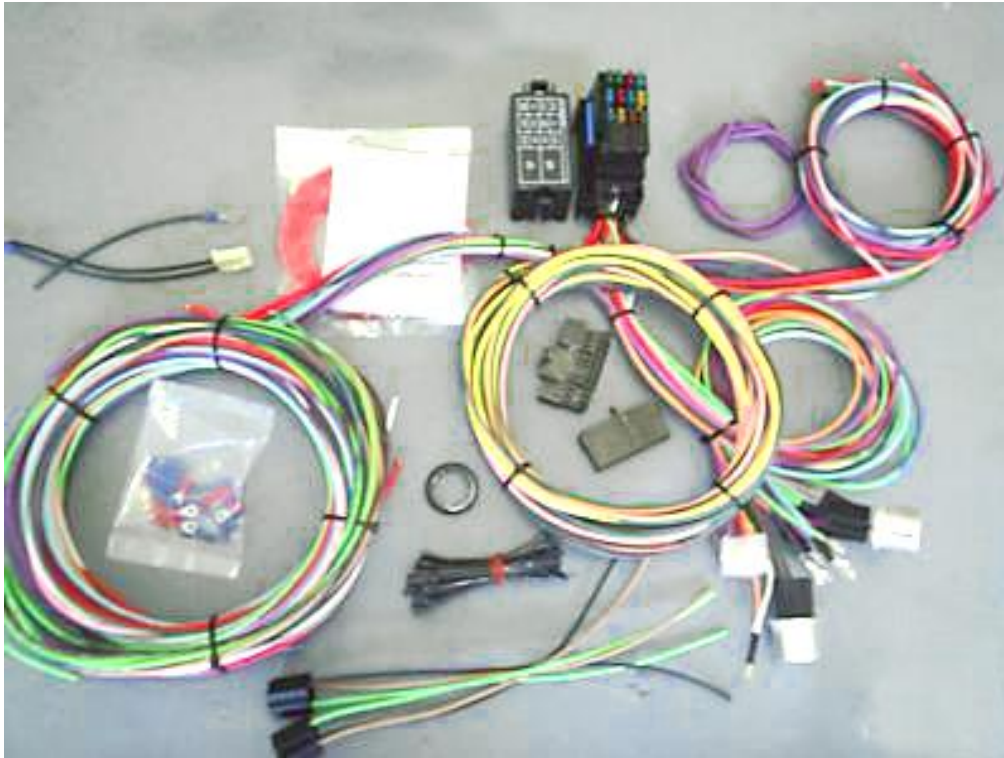
Imagen 3. Varios arnés de cableado típicos para automotores (Oficios técnicos, s.f.).
