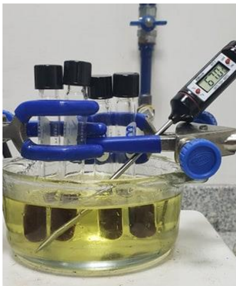
Figura 2. Montaje de la Reacción de Transesterificación
