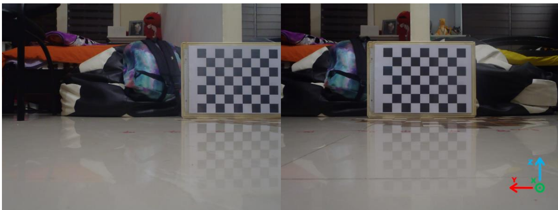
Figura 18. Par de imágenes separadas 40 cm para cálculo de profundidad
