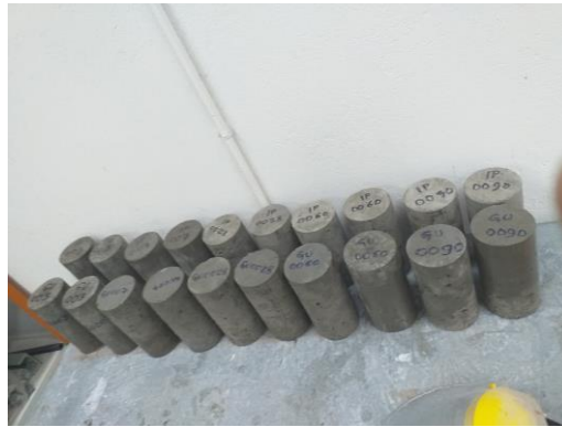
Figura A 5. Especímenes cilindros expuestos al aire libre (Cero días de curado).
