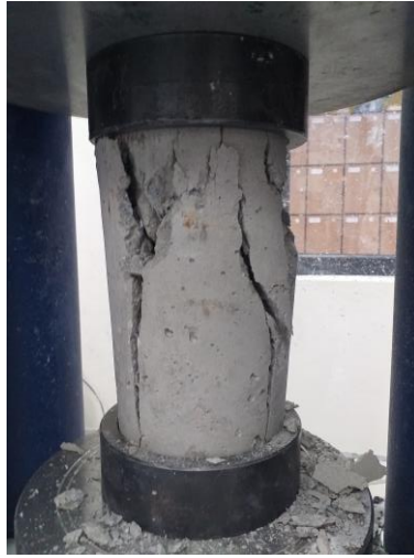
Figura A 10. Tipo de fractura en cilindros ensayados.
