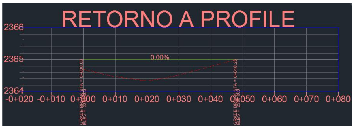
Figura 19: Perfil rasante curva de retorno calle A y subrasante
