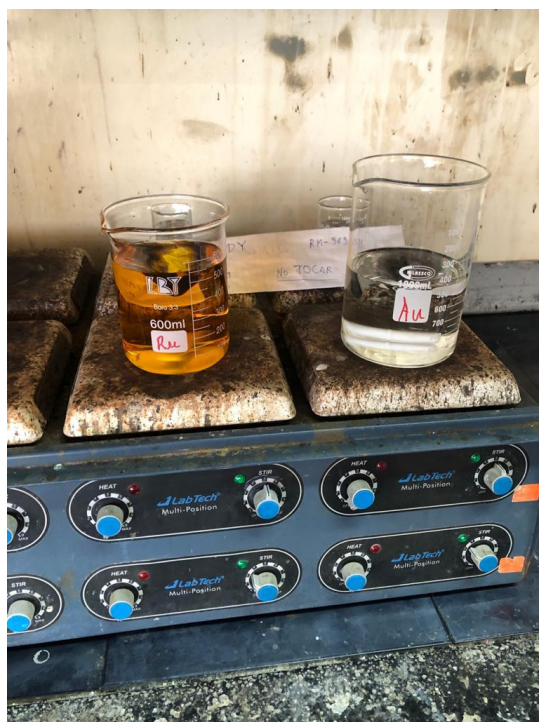
Figura 12. Proceso de impregnación de Ru y Pt sobre carbón activado en polvo a partir de soluciones estándar de Pt y Ru.
