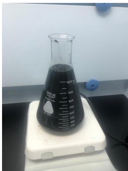
Figura 11. Proceso de agitación de Au sobre carbón activado en polvo a partir de una solución estándar de Au (1000 mg/L).
