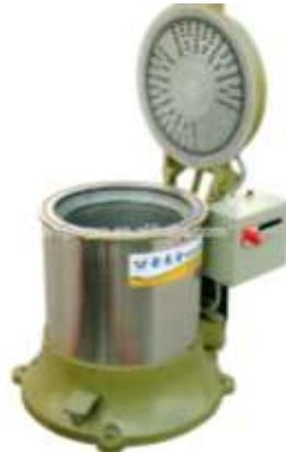
*Figura 12. Unidad de centrifugación para secado de micropartículas.*
