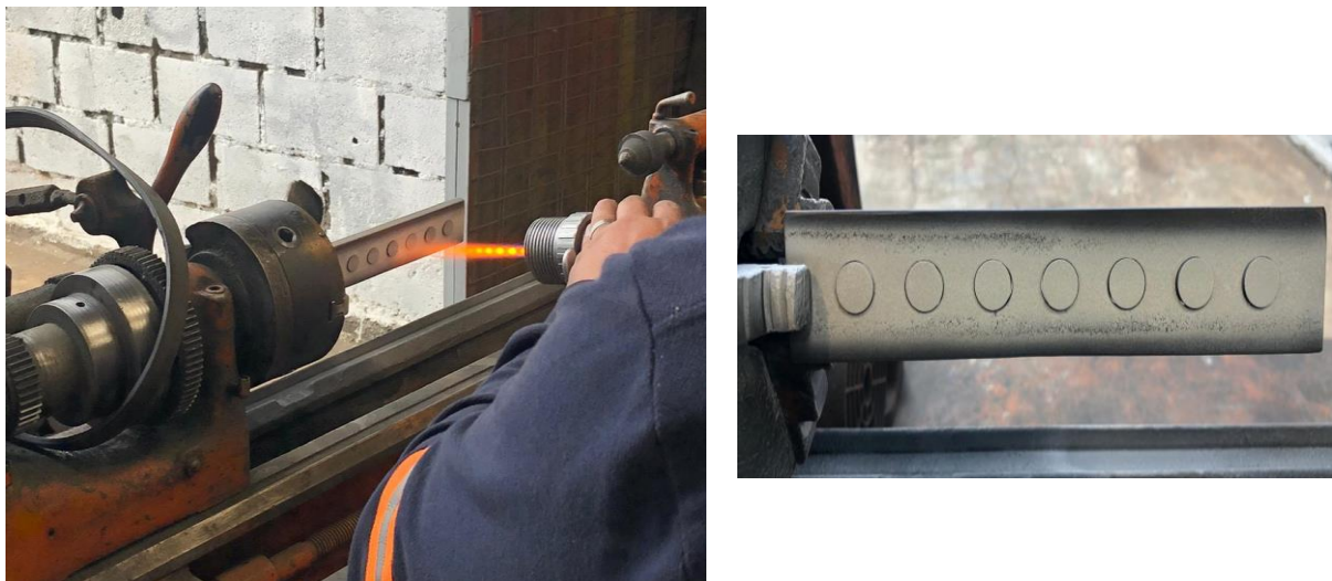
Figura 2. Proceso de Termorociado por HVOF sobre los sustratos de Ti6Al4V
