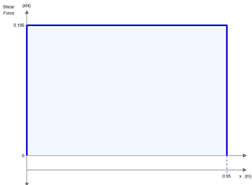
Figura 39: Diagrama esfuerzo cortante del cuerpo 4 (Calculadora libre de la viga / Momento de flexión, Cizalla fuerza y la deformación de la calculadora / SkyCiv, n.d.).
