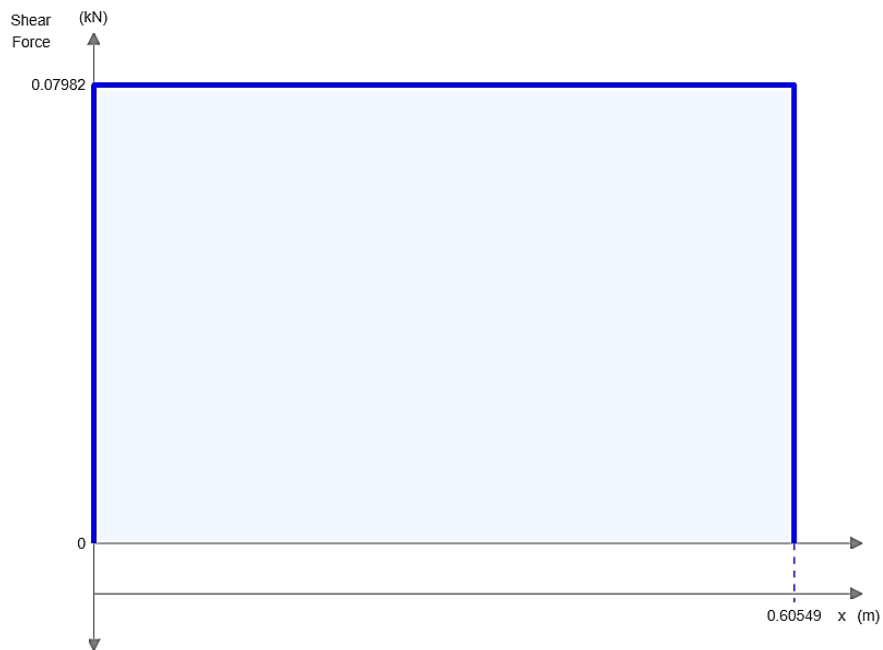
Figura 33: Diagrama esfuerzo cortante del cuerpo 2 (Calculadora libre de la viga / Momento de flexión, Cizalla fuerza y la deformación de la calculadora / SkyCiv, n.d.).
