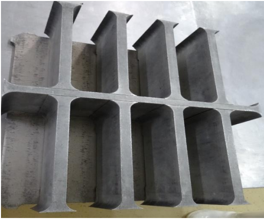
Horma de formado (formar cajetines con lámina base)
