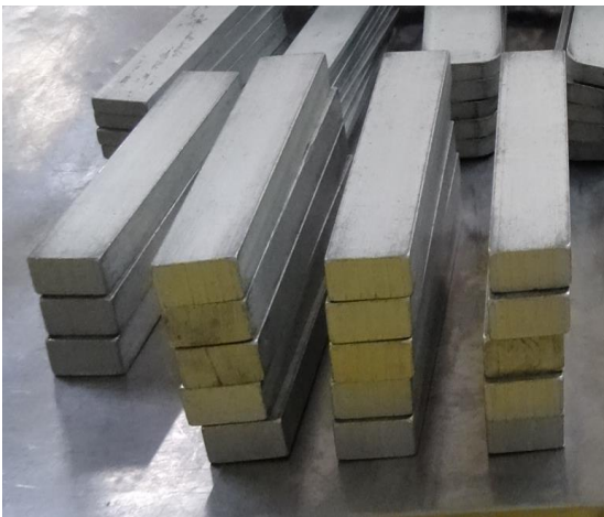
Alzas de formado de aluminio (formar cajetines de diferentes profundidades, 3 diferentes espesores)
