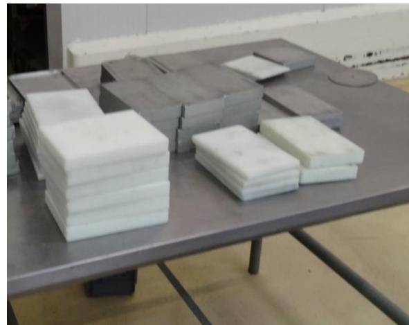
Alzas de sellado de teflón ( sellar cajetines de diferentes profundidades, 3 diferentes espesores)
