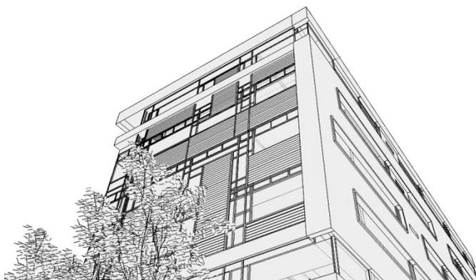
Con un 70% de vidrio, permite demasiado paso de rayos solares. Por ello se diseñó un sistema de doble muro para controlar de calor y rayos solares por la tarde. El vidrio utilizado es un vidrio que no permite que ingrese el calor. La vegetación en la fachada es una necesidad por brindar al edificio
