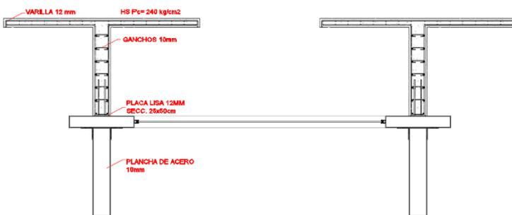
Figura 35: Detalle constructivo tragaluz coliseo
