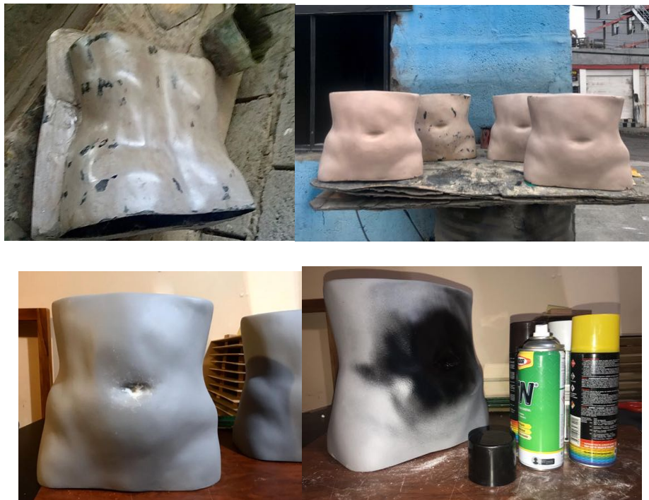
Figuras (16 – 17 – 18 – 19), Proceso de fabricación de esculturas en fibra de vidrio.
