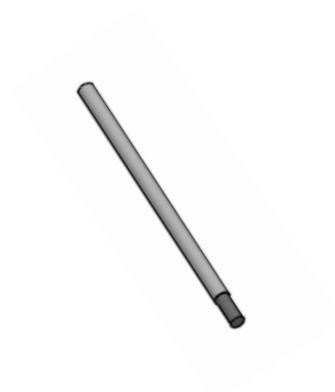
Figura 18. Sketch eje agitador para la tolva de la masa.
