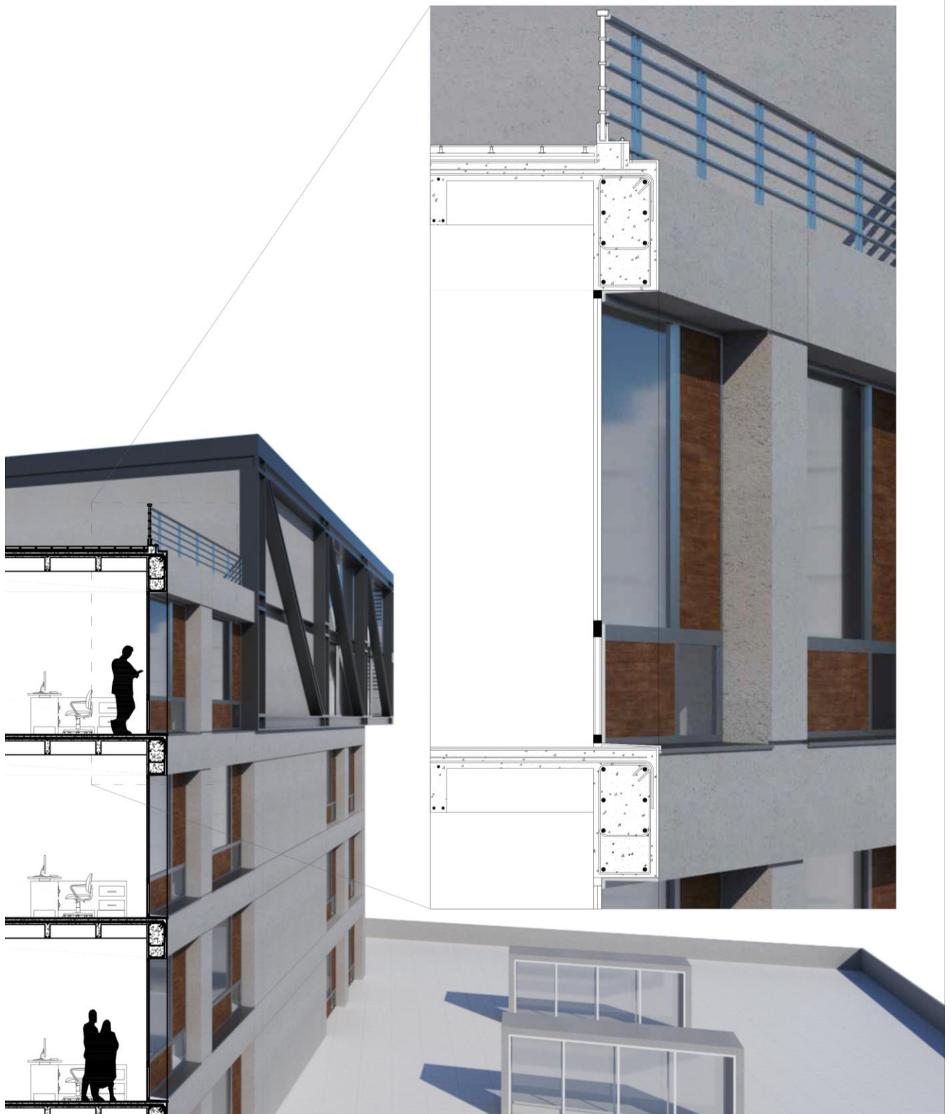
Figura 30. Corte por fachada. Elaboración propia.
