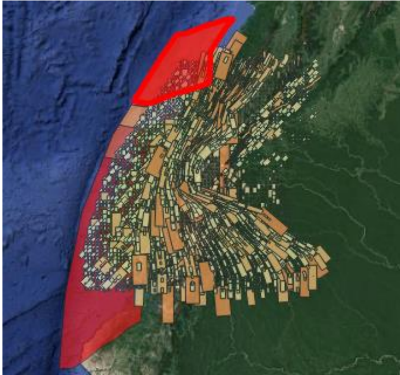
Ilustración 13: Plano de falla encontrado en el modelo de amenaza sísmica Elaborado por Jadira Llugsha
