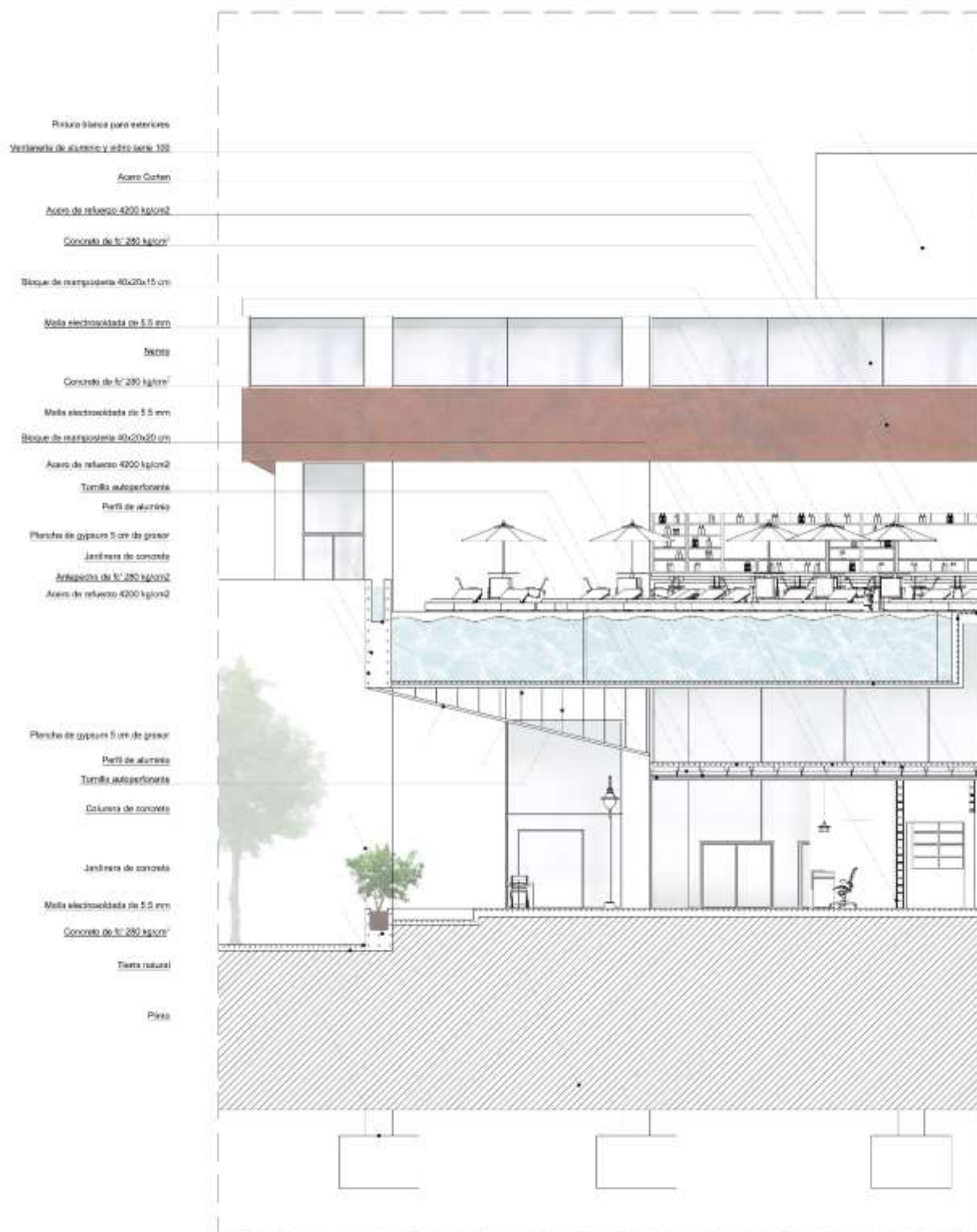
Corte Fachada 2 Figura 66: Elaboración Propia
