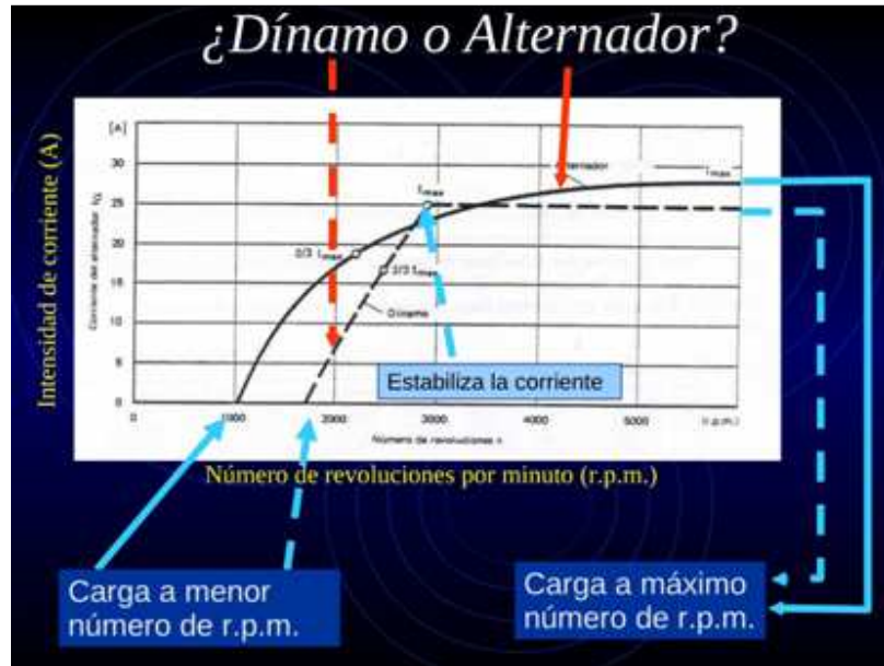
Figura 4.4.9 Curva del funcionamiento del alternador
