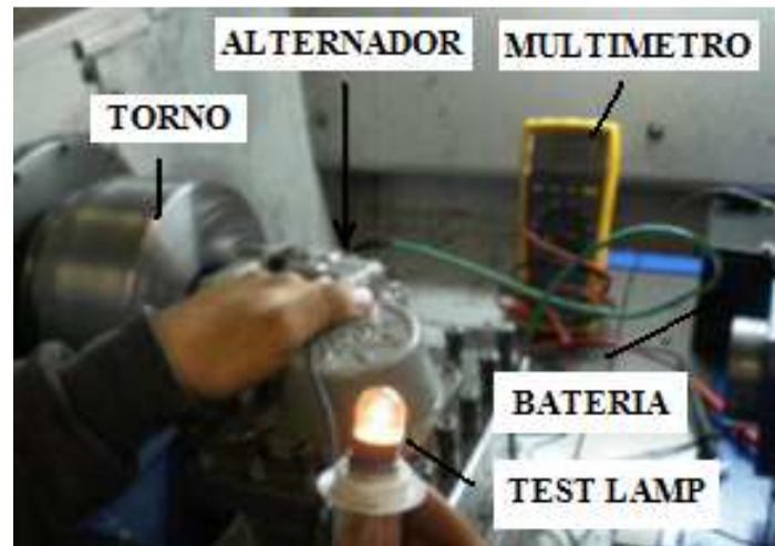
Figura 5.2. Esquema del circuito de prueba del alternador
