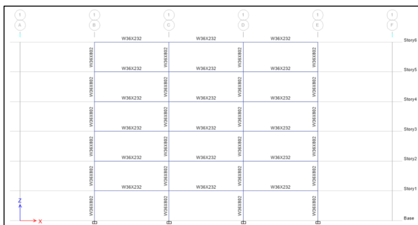
Figura 14. Configuración de los pórticos especiales a momento 1 y 5, dirección X.
