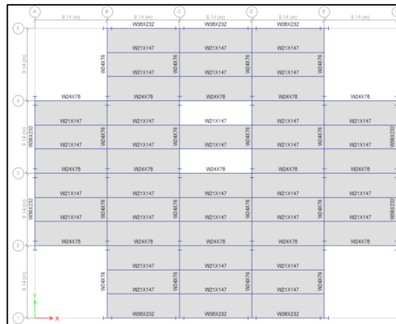
Figura 12. Configuración en planta de la estructura.
