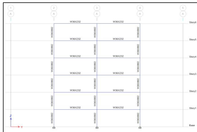
Figura 13. Configuración de los pórticos especiales a momento A y F, dirección Y.
